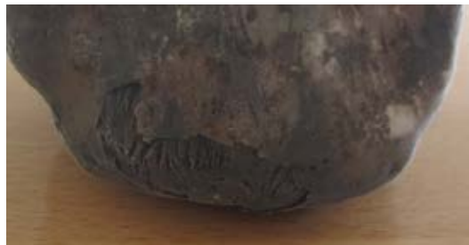
Figura 23: Zona parcialment espellofada d'una peça cuita a 60°C més de la temperatura recomanada.
