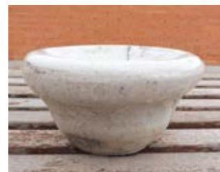
Figura 4: Peça cuita a temperatura superior a la d'estirada.
