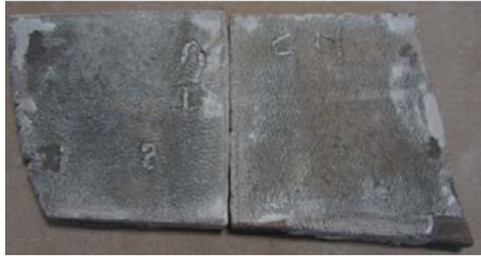
Figura 16: Peça de superfície rugosa cuita a baixa temperatura.
