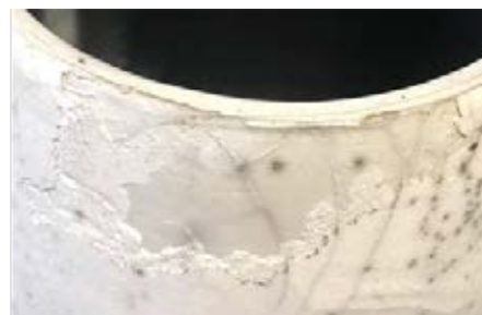
Figura 3: Detall de les capes superposades en una peça cuïta.
